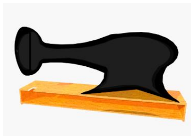
Рис. 6. Корпус та станина швейної машини у розрізі
