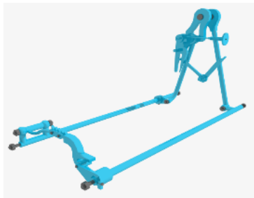
Рис. 4. Кривошипно-шатунний механізм голки з регулятором довжини стібка та рейкою
