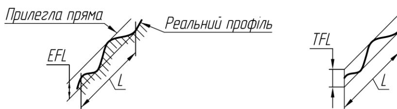
Рис. 2.4 - Відхилення ( EFL ) та допуск ( TFL ) прямолінійності в площині
