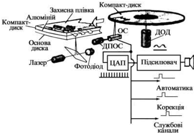
Рис. 5.12. Основні елементи цифрового лазерного програвача: ОС – оптична система (лазерний звукознімач); ДПОС – двигун приводу (поступового радіального зміщення в процесі програвання компакт-диску) оптичної системи (лазерного звукознімача); ДОД – двигун обертання диску; ЦАП – цифро-аналоговий перетворювач
