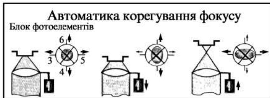
Рис. 5.15. Принципова схема автоматичного слідкування за доріжкою на компакт-диску і автоматичного фокусування променя лазера
