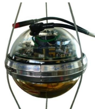
Рис. 3. Оптичний модуль детектора нейтрино AMANDA в північній півкулі
